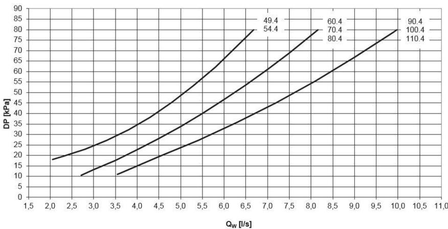
Le perdite di carico lato acqua sono calcolate considerando una temperatura media dell'acqua di 65°C
