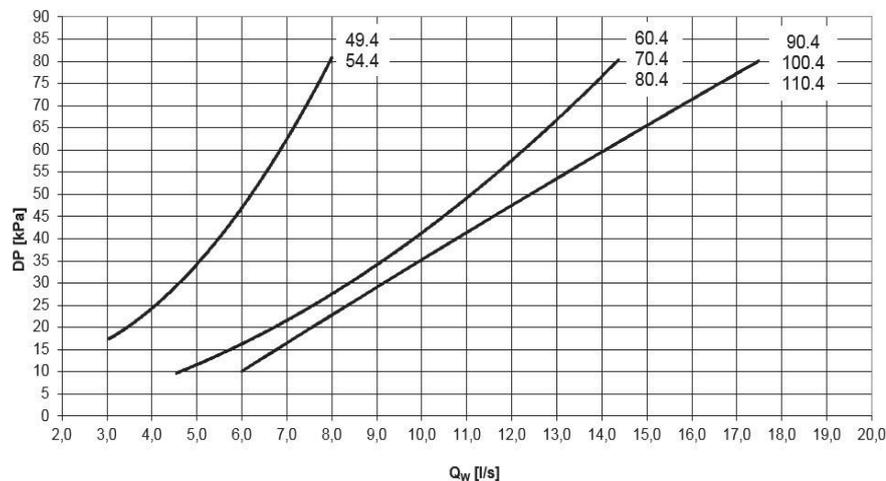
Le perdite di carico lato acqua sono calcolate considerando una temperatura media dell'acqua di 65°C
