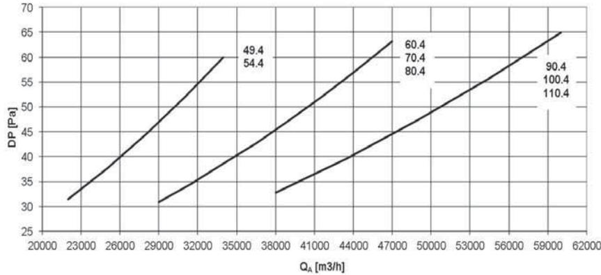
Le perdite di carico lato aria sono relative alla temperatura media dell'aria di 20°C con aletta asciutta e sono da aggiungersi alle perdite dovute a canali, bocchette e quant'altro induca un calo di prevalenza utile.
