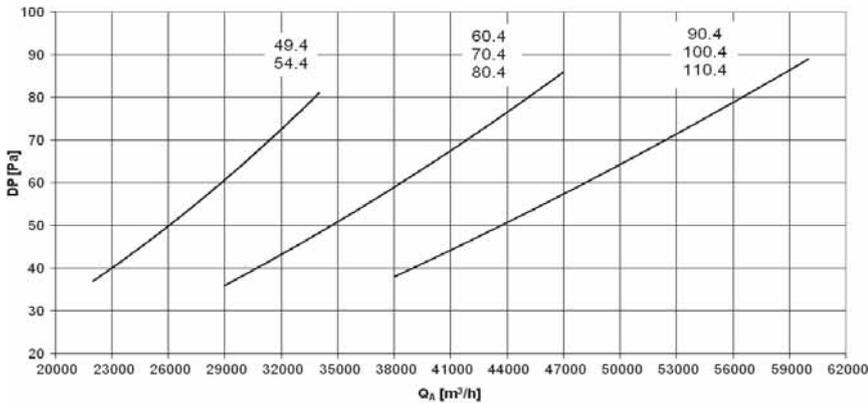
Le perdite di carico lato aria sono relative alla temperatura media dell'aria di 20°C con aletta asciutta e sono da aggiungersi alle perdite dovute a canali, bocchette e quant'altro induca un calo di prevalenza utile.
