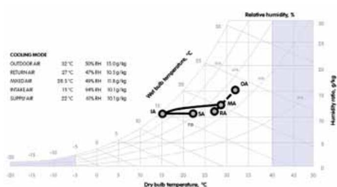
Esempio di trattamento a pieno carico per CLIVETPACK modello CSRT-XHE2 49.4 in portata aria standard. Portata di aria esterna pari a 30% di quella trattata. Unità completa dell'opzione 'Postriscaldamento a gas caldo'.
