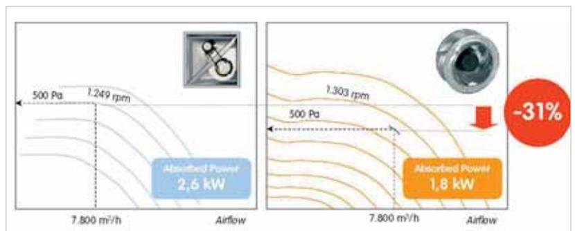
Potenza elettrica assorbita dal motore elettrico, dati costruttore - Esempio riferito a portata di 7.800 m<sup>3</sup>/h con pressione statica utile pari a 500 Pa.
