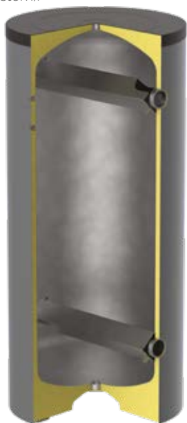
VKR Kohlenstoffstahl Äußere Rostschutzlackierung Kondensationshemmende Wärmedämmung Geeignet für die Installation mit Layout 2 (Zweikreisystem). Die Führungsrohre fördern den Kaltwasser-Durchfluss vom Primär- zum Sekundärkreislauf. Der Speicher ist für mittlere und hohe Durchflussmengen geeignet.
