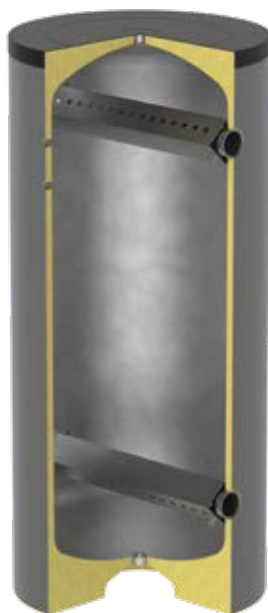
VKD Kohlenstoffstahl Äußere Rostschutzlackierung Kondensationshemmende Wärmedämmung Geeignet für die Installation mit Layout 2 (Zweikreisystem). Die Innentemperatur des Speichers wird durch die Verteilerrohre homogener gemacht.
