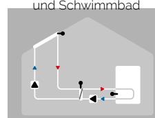
Solarthermie mit Wärmetauscher
