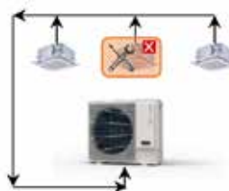
Refrigerante accumulato nella ODU
