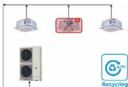
Refrigerante accumulato nella ODU
