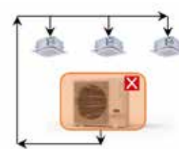
Refrigerante accumulato nelle IDU
