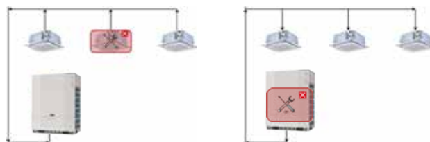
Refrigerante accumulato nella ODU Refrigerante accumulato nelle IDU
