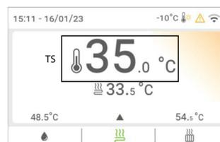
L'appel à l'unité peut se faire depuis l'interface utilisateur (grâce à la sonde de température intégrée) ou depuis le thermostat électromécanique. Dans le second cas, le thermostat de zone ne peut contrôler le changement de mode Chauffage / Refroidissement que s'il est équipé de doubles relais, sinon il doit être géré par l'IHM.
