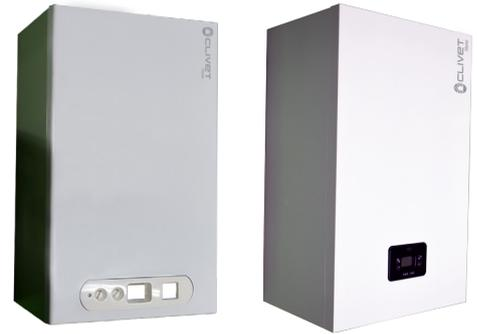
Le caldaie per versioni ibride "Factory made" sono di tipo C, a camera stagna e tiraggio forzato: richiedono ingresso aria e scarico fumi collegati attraverso dei condotti realizzati con tubi coassiali o separati, con canne fumarie indipendenti o comuni.
