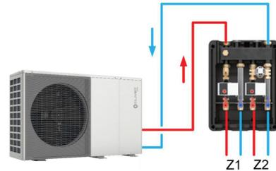
*Nota: per la gestione di impianti con Zona 2 miscelata, installare la sonda di temperatura in dotazione sul tubo di mandata della Zona 2 di KIRE2HLX*
