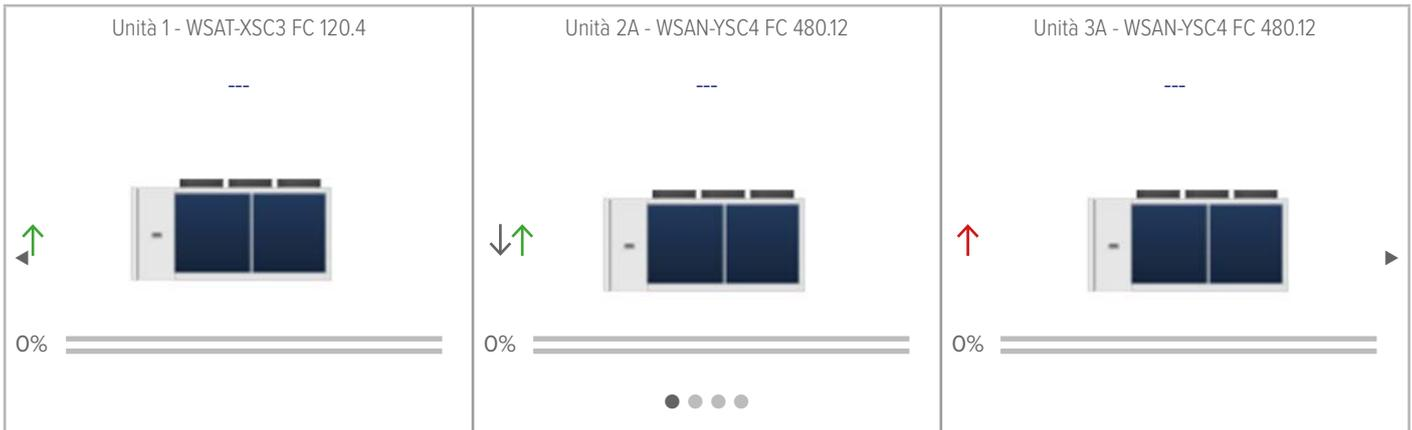
Una volta stabilita la necessità di inserimento o disinserimento di nuove risorse (unità e/o gradini di potenza), l'algoritmo di ottimizzazione si occupa di selezionare la migliore sequenza da attivare per soddisfare i carichi caldi e freddi di impianto, consentendo altresì di inseguire le variazioni di carico in modo puntuale minimizzando gli sprechi derivanti da possibili sovra produzioni di energia termica.
