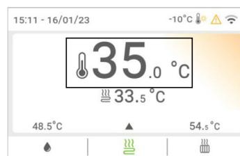
Der Aufruf für das Gerät kann von der Benutzerschnittstelle (dank des integrierten Temperaturfühlers) oder von einem elektromechanischen Thermostat aus erfolgen. Im zweiten Fall kann das Zonenthalermostat die Änderung des Heiz-/Kühlmodus nur steuern, wenn es mit einem Doppelrelais ausgestattet ist, andernfalls muss es von der MMS aus verwaltet werden.
