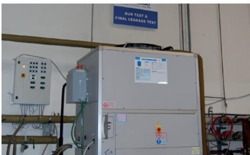
Il ciclo di produzione volge al suo termine presso la stazione di collaudo. Qui tutte le unità sono testate individualmente per verificare il loro corretto funzionamento, eseguire la carica di refrigerante e configurare le impostazioni del microprocessore.
