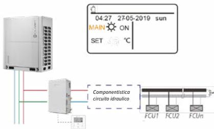
• **Scenario 2:** applicazione riscaldamento ambiente con controllo della temperatura dell'aria.
