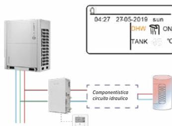
• **Scenario 4:** applicazione acqua calda sanitaria e riscaldamento ambiente simultanei.
