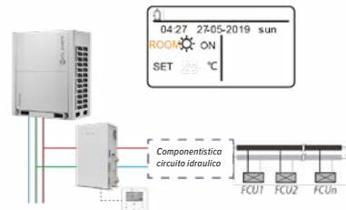
• **Scenario 3:** applicazione acqua calda sanitaria con controllo della temperatura nell'accumulo.
